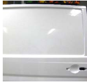
einfache Vertiefung / Sicke
